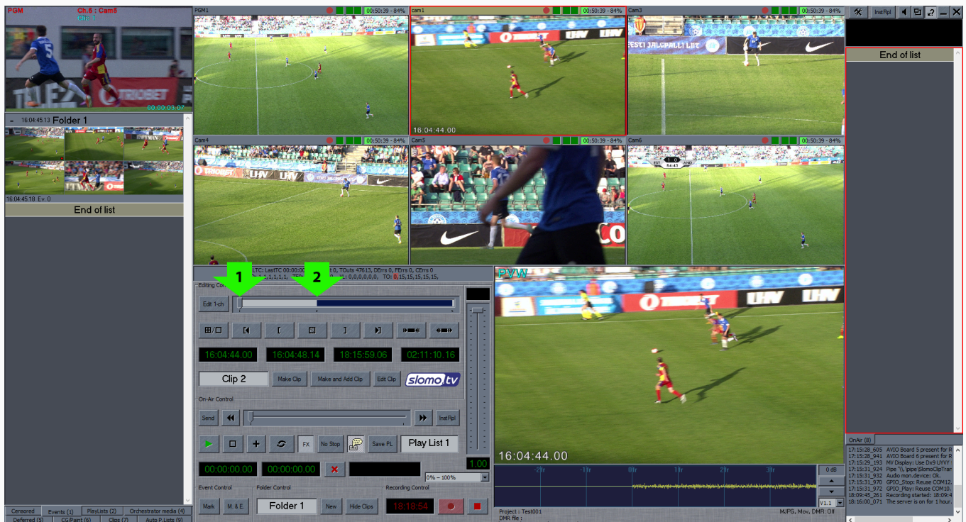
Рисунок 46 – Разметка точки входа
