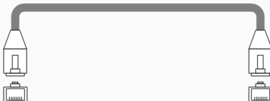
Рисунок 5 – Кабель для подключения пульта по Ethernet
