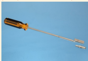
Рисунок 1 – Инструмент для разъединения разъемов Din 1.0/2.3
